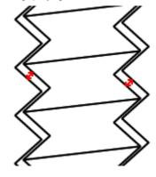
この送りネジでは、バックラッシュを極力抑えながらも潤滑 油が浸透できる程度の極限のクリアランスを確保することが 求められています。
