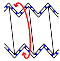
この送りネジ(雄ネジ)は、ネジ研削盤で研削した後に、 ラッピングという仕上げの研磨を行います。ラッピングと は、ラップ粉(ラップ剤)によって表面の微細なデコボコ を摺り合わせる作業です。左図のように、油でといたラッ プ粉をラップリングと呼ばれる部材に塗布し、送りネジと ラップリングを摺り合わせます。
