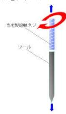
当社の送りねじは、1 秒間に数回~数十回もの高速上下運動を繰り返す、半導体製造装置の中枢部品の一部として使われています。
