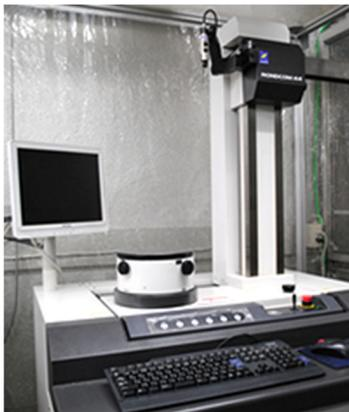
また、東京精密社製の最新の真円度測定機を導入し、高いレベルの品質/精度の確認を行っています。
